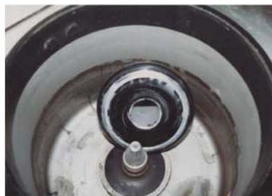
(図1)超遠心機のチャンバー内で遠心ローターが外れている様子
